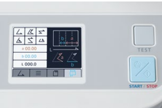
IDEAL 8345: Bedienfeld mit Touchscreen Alle Einstellungen erfolgen über den intuitiv zu bedienenden Touchscreen. Leicht verständliches Fehlermanagement mit Lösungsvorschlägen zur Behebung.
