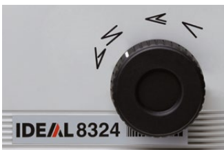
IDEAL 8324: Selektionsrad Die Einstellung der gewünschten Falzart erfolgt sekundenschnell und bequem über das praktische Selektionsrad.
