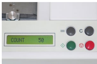
IDEAL 8306: Bedienelement Vier Drucktasten und ein Display für den Total- und Vorwahlzähler ermöglichen eine besonders einfache, unkomplizierte Bedienung.
