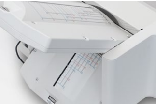
IDEAL 8345: Falzarten per Knopfdruck Per Tastendruck wird die Falzart gewählt und die Anschläge in den Falztaschen werden automatisch per Elektromotor angefahren.
