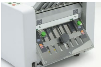
IDEAL 8306: Falzpositionen Farbcodes markieren die Anschlagpositionen auf beiden Falztaschen für die vier möglichen Falzarten.
